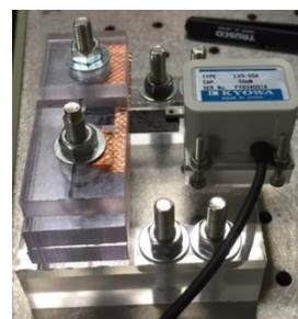
第 2.3 図 CNA 発生力計測実験治具
