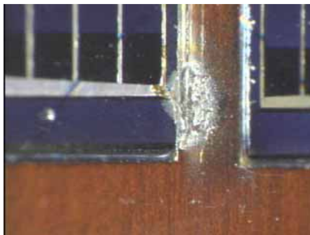
図4：PN接合短絡箇所で見られる放電痕の写真（斜め30度から撮影）
