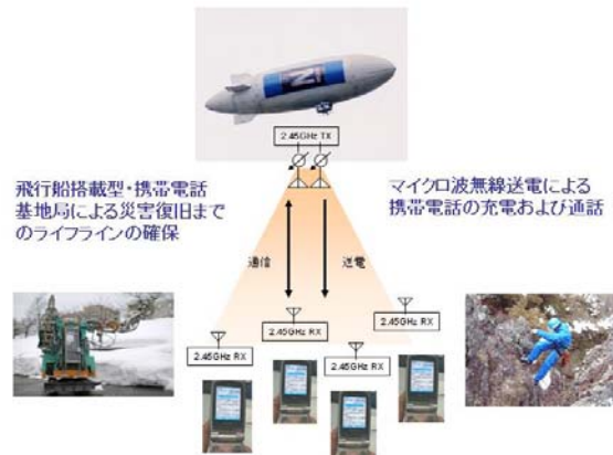
図6 将来の災害時のad hocな携帯電話基地局・兼・無線送電通話システム
