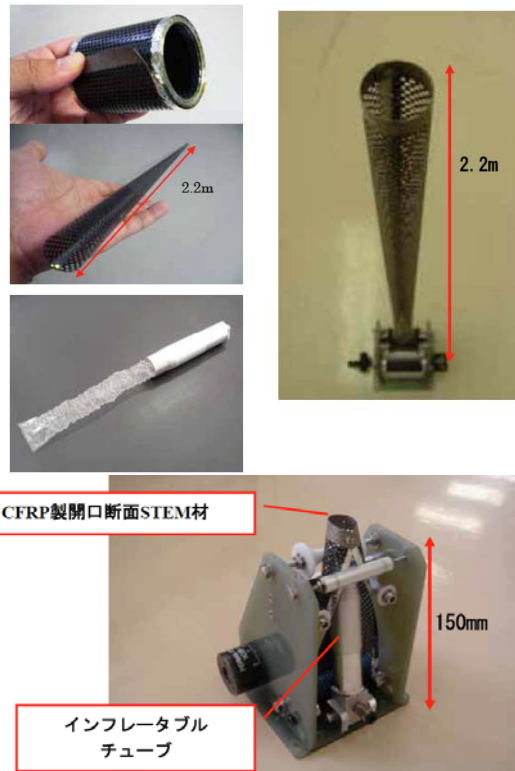
図2 インフレーターブル方式一次元伸展構造
