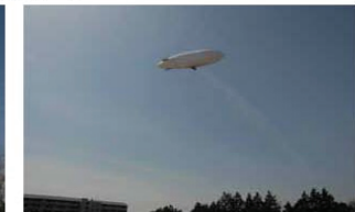
無線電力伝送装置を搭載した飛行船(高度30m)
