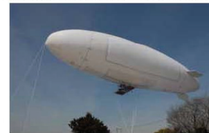
無線電力伝送装置を搭載した飛行船(高度30m)
